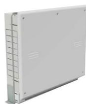
Cassetta in acciaio zincato regolabile in profondità da 80 mm a 130 mm con coperchio in ABS verniciabile per l'alloggiamento dei collettori e dei gruppi di miscelazione.
