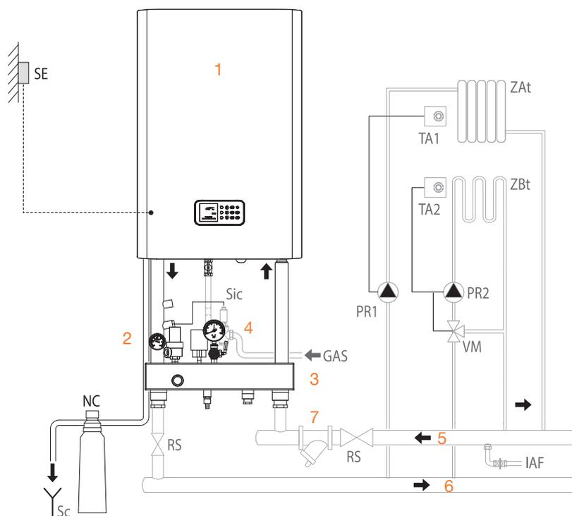
Gestione di una zona ALTA TEMPERATURA, di una zona BASSA TEMPERATURA con regolazione esterna.
