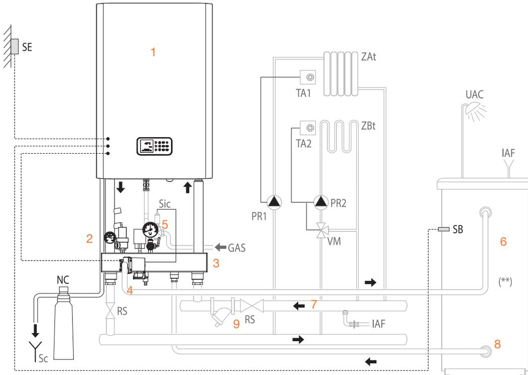
**Gestione di una zona ALTA TEMPERATURA, di una zona BASSA TEMPERATURA con regolazione esterna e di un BOLLITORE remoto direttamente da generatore di calore.**
