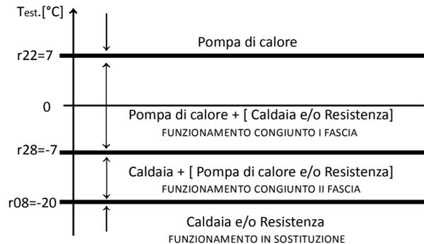
In caso di necessità di variazione dei valori dei parametri **r22**, **r28**, **r08**, rispettare  $r22 \geq r28 \geq r08$ .
