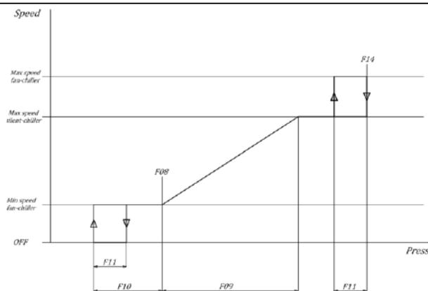
Nella modalità chiller è attivo un periodo di preventilazione: prima dell'accensione del compressore, il ventilatore viene acceso per 5 secondi; la velocità del ventilatore è proporzionale alla temperatura di condensazione, tuttavia, se il regolatore richiede il cut-off durante questo periodo, il ventilatore va alla velocità minima impostata. Questa funzione impedisce che il compressore parta con temperature di condensazione troppo elevate.
